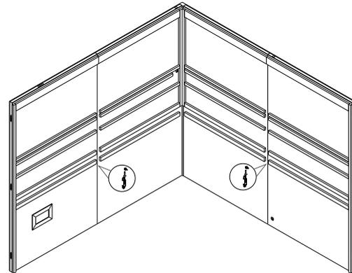
Montieren Sie die restlichen Rückwände sowie die Blendleisten.
