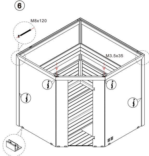
Montieren und verschrauben Sie den Rahmens der Vorderseite zusammen mit den seitlichen Glaselementen. Wenn der Boden ein späteres Verkleben mit Silicon nicht zulässt montieren Sie die Bodenwinkel ohne diese zu verschrauben.
