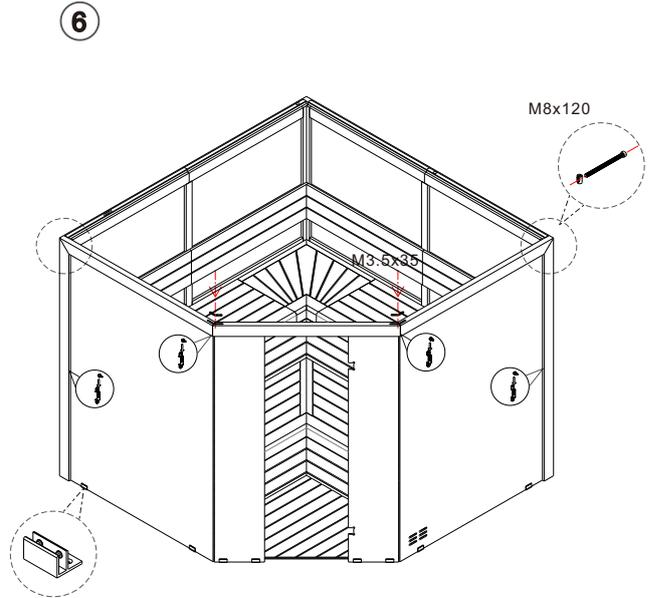
Montieren und verschrauben Sie den Rahmens der Vorderseite zusammen mit den seitlichen Glaselementen. Wenn der Boden ein späteres Verkleben mit Silicon nicht zulässt montieren Sie die Bodenwinkel ohne diese zu verschrauben.
