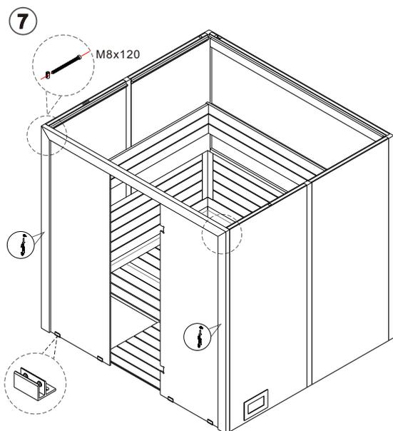
Montieren und verschrauben Sie den Rahmen der Vorderseite zusammen mit den seitlichen Glaselementen. Wenn der Boden ein späteres Verkleben mit Silicon nicht zulässt montieren Sie die Bodenwinkel ohne diese zu verschrauben.
