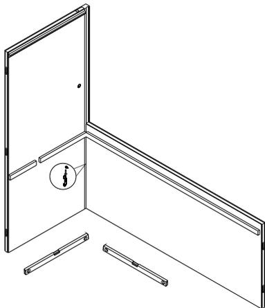
Stellen Sie sicher, dass der Boden eben ist. Verbinden Sie die linke Seitenwand (rechter Teil) mit der Rückwand (untere Teil) unter Verwendung eines Eckpfostens.
