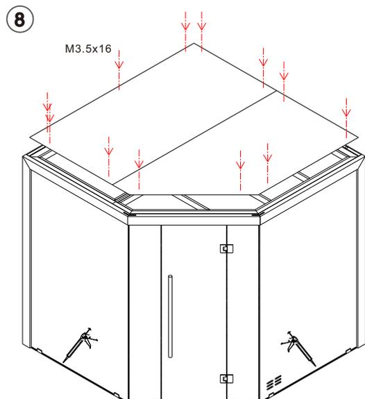
Montieren sie jetzt die Glastür und die Türgriffe. Montiert und verschrauben Sie die Deckenplatte. Danach verschrauben Sie die Bodenwinkel oder verkleben die Glasscheiben mit dem Boden.
