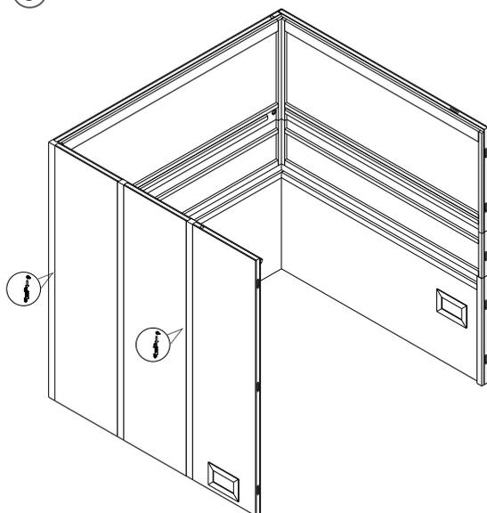
Im Anschluss können die restlichen Seitenwände montiert werden. Verwenden Sie zur Verbindung die beiliegenden Mittelpfosten, sowie den Eckpfosten.
