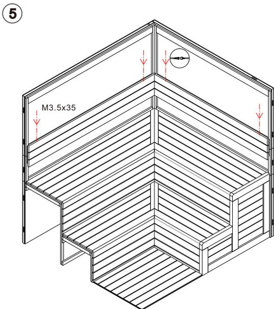
Montieren Sie je nach Modell den Saunaofen und verkabeln diesen, sowie die Beleuchtung. Montieren und verschrauben Sie zum Schluss die Sitze und die Rückenlehnen.
