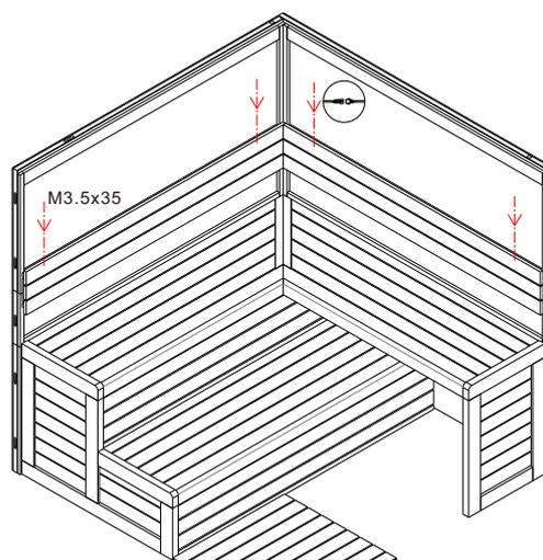
Montieren Sie je nach Modell den Saunaofen und verkabeln diesen, sowie die Beleuchtung. Montieren und verschrauben Sie zum Schluss die Sitze und die Rückenlehnen.
