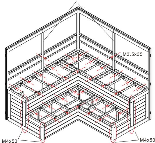
Montieren und verschrauben Sie die zuerst oberen Sitzunterkonstruktionen, sowie die oberen und seitlichen Blenden. Danach können die untere Sitzunterkonstruktionen, sowie die unteren Blenden montiert und verschraubt werden.
