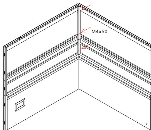
Montieren Sie als danach den oberen Teil der rechten und linken Steinrückwand. Ziehen Sie danach die Schrauben fest.
