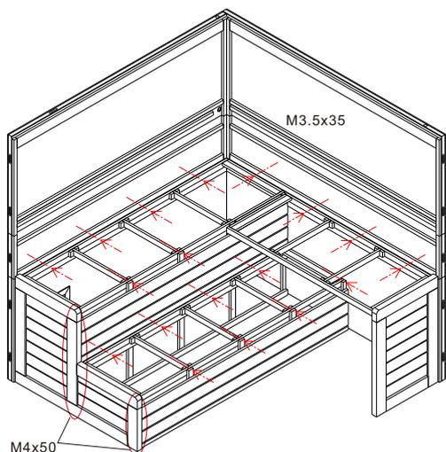
Montieren und verschrauben Sie die zuerst oberen Sitzunterkonstruktionen, sowie die oberen und seitlichen Blenden. Danach können die untere Sitzunterkonstruktionen, sowie die unteren Blenden montiert und verschraubt werden.
