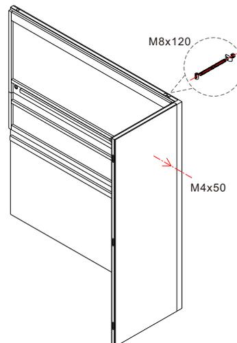
Montieren Sie jetzt den oberen Teil der Rückwand und verbinden Sie diesen mit der Seitenwand.
