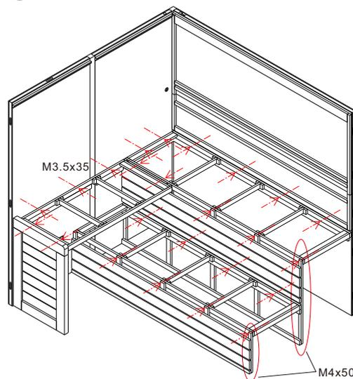
Montieren und verschrauben Sie die zuerst oberen Sitzunterkonstruktionen, sowie die oberen und seitlichen Blenden. Danach können die untere Sitzunterkonstruktionen, sowie die unteren Blenden montiert und verschraubt werden.
