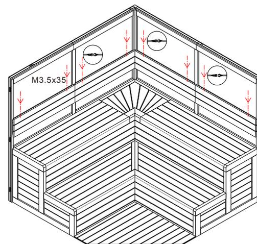
Montieren Sie je nach Modell den Saunaofen und verkabeln diesen, sowie die Beleuchtung. Montieren und verschrauben Sie zum Schluss die Sitze und die Rückenlehnen.
