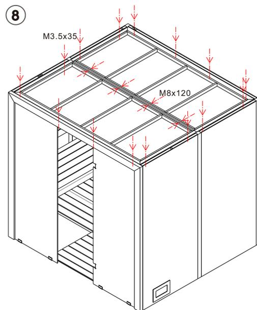
Montieren und verschrauben Sie die Dachelemente wie in der Zeichnung dargestellt und ziehen Sie die Schrauben fest.
