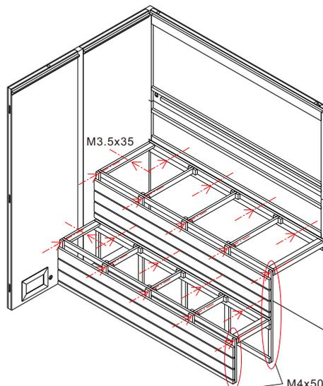
Montieren und verschrauben Sie die zuerst oberen Sitzunterkonstruktionen. Danach können die untere Sitzunterkonstruktionen, sowie die unteren Blenden montiert und verschraubt werden.
