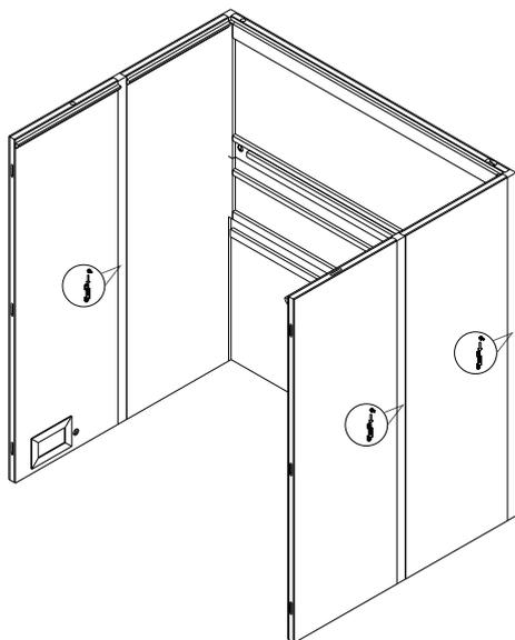
Im Anschluss können die restlichen Seitenwände montiert werden. Verwenden Sie zur Verbindung die beiliegenden Mittelpfosten, sowie den zweiten Eckpfosten.
