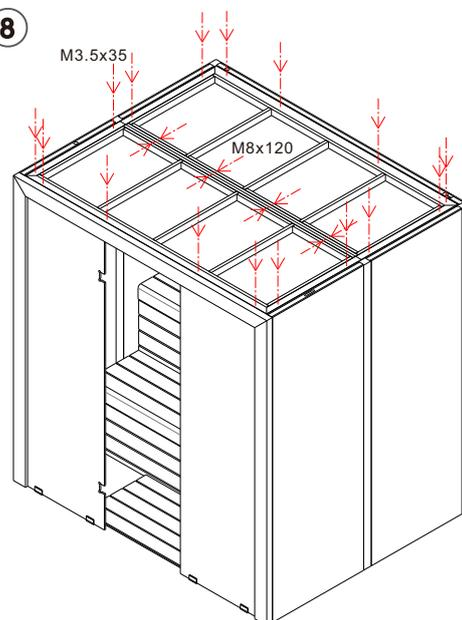
Montieren und verschrauben Sie die Dachelemente wie in der Zeichnung dargestellt und ziehen Sie die Schrauben fest.
