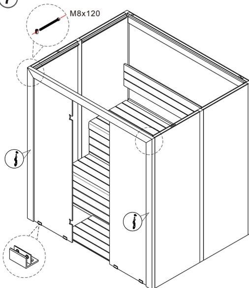
Montieren und verschrauben Sie den Rahmen der Vorderseite zusammen mit den seitlichen Glaselementen. Wenn der Boden ein späteres Verkleben mit Silicon nicht zulässt montieren Sie die Bodenwinkel ohne diese zu verschrauben.
