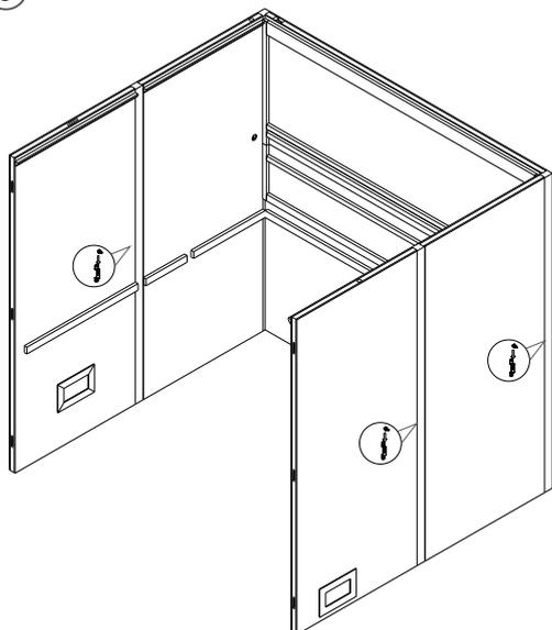
Im Anschluss können die restlichen Seitenwände montiert werden. Verwenden Sie zur Verbindung die beiliegenden Mittelpfosten, sowie den zweiten Eckpfosten.
