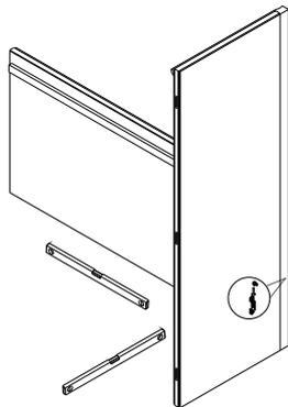
Stellen Sie sicher, dass der Boden eben ist. Verbinden Sie die rechte Seitenwand (linker Teil) mit der Rückwand (untere Teil) unter Verwendung eines Eckpfostens.
