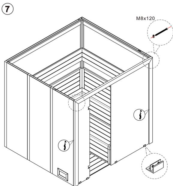
Montieren und verschrauben Sie den Rahmen der Vorderseite zusammen mit den seitlichen Glaselementen. Wenn der Boden ein späteres Verkleben mit Silicon nicht zulässt montieren Sie die Bodenwinkel ohne diese zu verschrauben.
