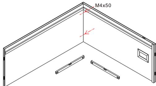
Stellen Sie sicher, dass der Boden eben ist. Verbinden Sie die rechte Seitenwand (untere Teil) mit der mittleren Rückwand (untere Teil).
