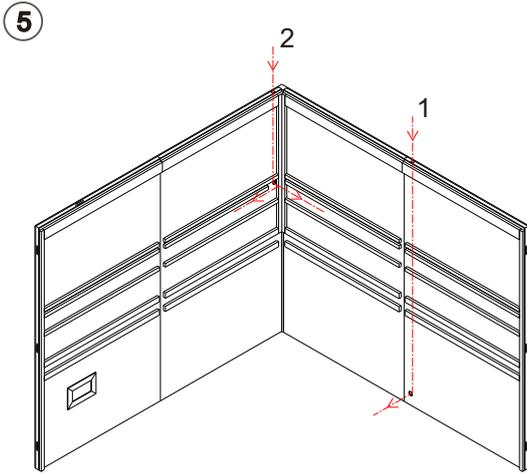
Für den elektrischen Anschluss sind werkseitig zwei Kabelkanäle vorbereitet:
