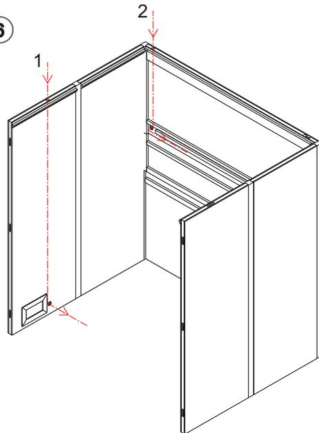
Für den elektrischen Anschluss sind werkseitig zwei Kabelkanäle vorbereitet:
