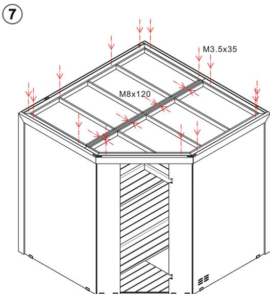
Montieren und verschrauben Sie die Dachelemente wie in der Zeichnung dargestellt und ziehen Sie die Schrauben fest.
