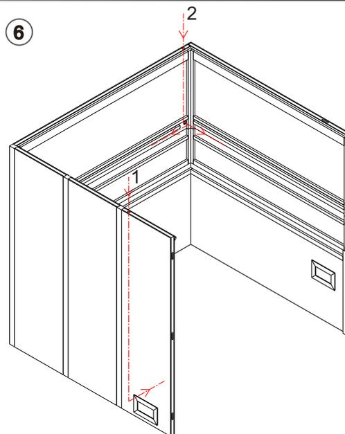
Für den elektrischen Anschluss sind werkseitig zwei Kabelkanäle vorbereitet:
