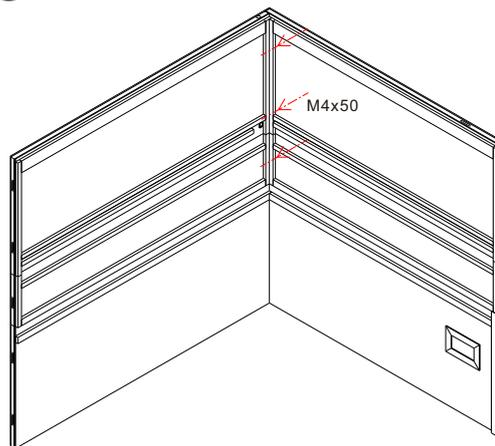
Montieren Sie danach die beiden oberen Steinwände. Ziehen Sie danach die Schrauben fest.
