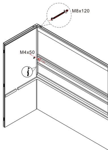
Montieren Sie jetzt den oberen Teil der Rückwand und verbinden Sie diesen mit der Seitenwand.
