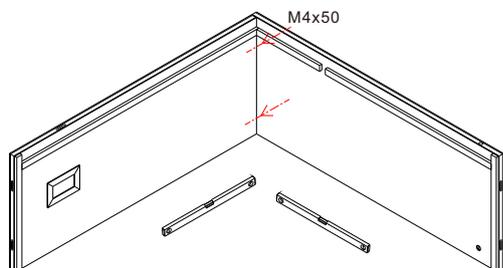
Stellen Sie sicher, dass der Boden eben ist. Verbinden Sie die rechte Rückwand (untere Teil) mit der linken Rückwand (untere Teil).
