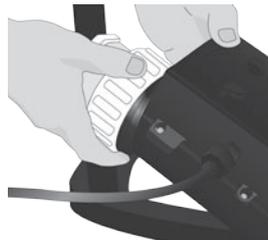
Setzen Sie die beiden Kunststoffmutter auf die Gewinde des in.clear auf, und ziehen Sie diese an.
